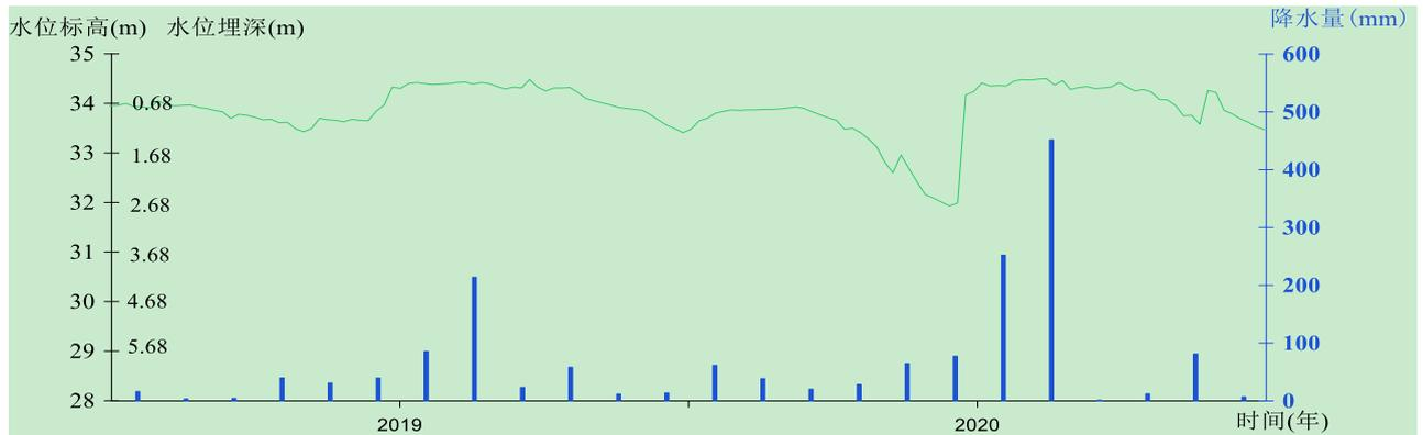
图 5.3-8 鱼台县 3708270009 号孔多年孔隙潜水水位与降水量关系对比图
